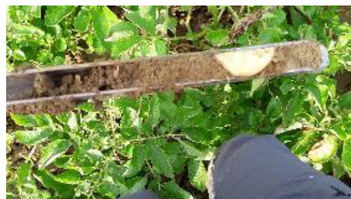
Sondes tensiométriques connectées, sonde capacitive connectée, humidité du sol sur 25 cm à l'aide d'une gouge – Photos CA31
