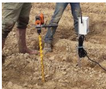
Sondes tensiométriques connectées, sonde capacitive connectée, humidité du sol sur 25 cm à l'aide d'une gouge – Photos CA31
