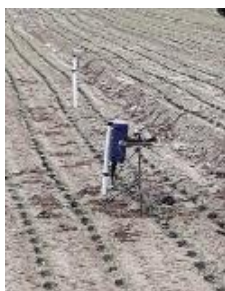
Sondes tensiométriques connectées, sonde capacitive connectée, humidité du sol sur 25 cm à l'aide d'une gouge – Photos CA31
