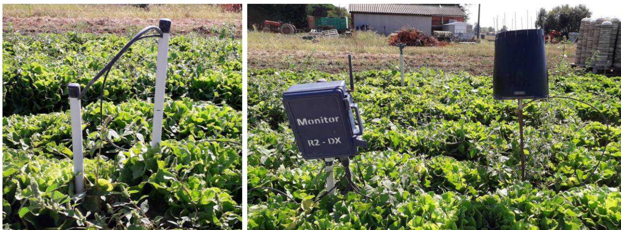
A gauche : jeu de 2 sondes tensiométriques – à droite : moniteur de collecte et d'envoi des données et pluviomètre connecté
