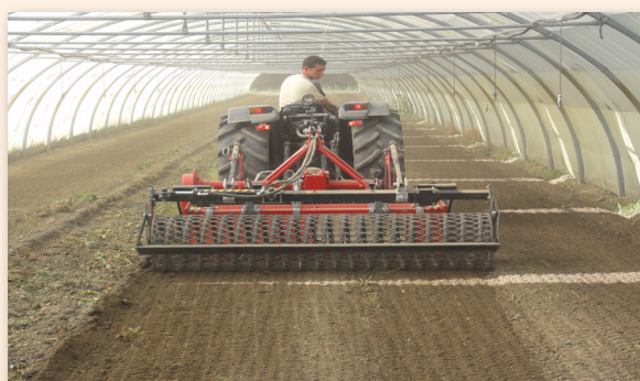
Passage d'un rouleau enfouisseur de pierres
