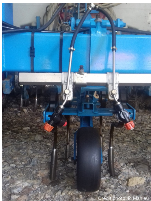
Désherbeuse avec système de pulvérisation directe
