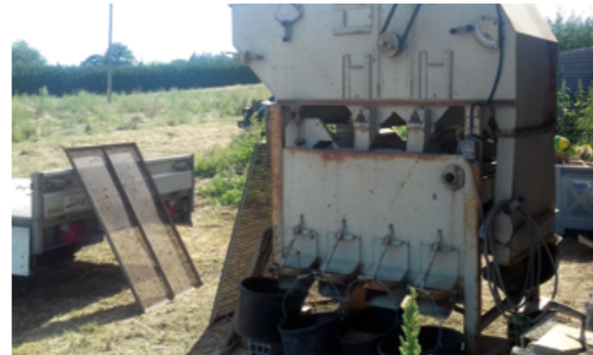
Pour ce type d'appareil, il existe 30 grilles classées tous les 0,5 mm (0,5 - 1 - 1,5 - 2 ...15 mm).
