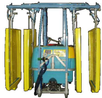
S21 - Panneaux récupérateurs
