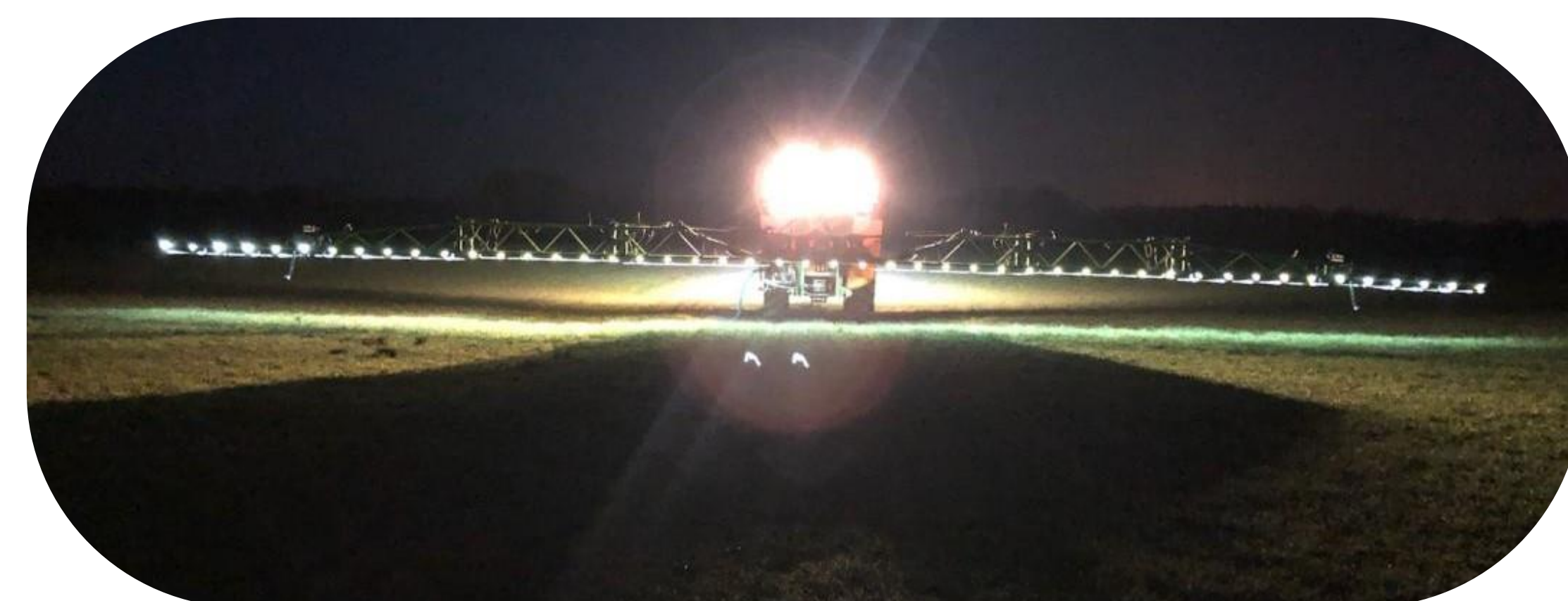
Pulvérisation de nuit avec éclairage de la rampe au leds.
